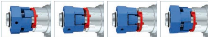
Für Rechtseinbau eingestelltes Getriebe am Rohrmitnehmer nach links drehen ...
