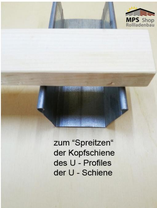
Werkzeug schräg, ca. 30° zur U-Schiene, ansetzen und bis auf 90° zur U-Schiene verdrehen.
