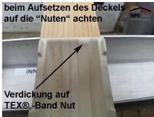
Darauf achten, dass der Deckel der TEX®.-Bandspule wieder seitenrichtig aufgesetzt wird.
