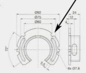
Unterschied zwischen 462F070 und 462F071 sind Ausbuchtungen ggf. zur Fixierung in Blendkappen von Vorbau oder Aufsatzelementen.
