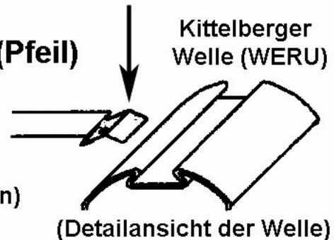
Ausbau durch "aushebeln" mit flachem Schraubendreher,
