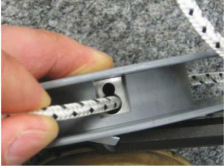
Eine Nahaufnahme zeigt die weiße, geflochtene Schnur, die einmal um die Federdose gewickelt ist. Die Schnur ist durch ein Doppelloch an der Außenseite der Federdose geschoben.                        | <p>Die Schnur einmal um die Federdose wickeln.<br/>Das Schnurende in das Doppelloch an der Außenseite der Federdose schieben (min. 3 cm tief!).</p> |
