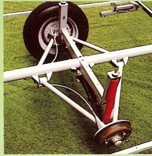
Die unabhängige Federung mit Stabilisatorstangen und Stossdämpfern.
