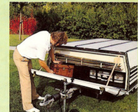
Die vorderen und hinteren Gepäckräume sind auch unterwegs erreichbar. Achten Sie auf den speziellen Platz für das Vorzeltgestänge.
