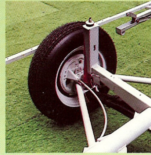
Detailaufnahme der Reserveradaufhängung mit Stossdämpfer und Bremstrommel.
